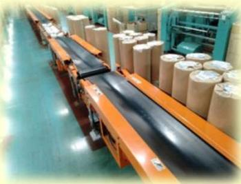
回転ラックはシステムと連動している為、次に出庫すべき棚を自動で呼び出します。カット機にて指定m数を裁断しシュリンク機で梱包しております。
