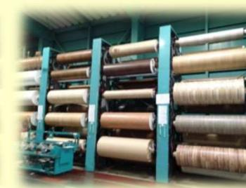
壁紙同様、固く分厚いクッションフロアもカット機を使って裁断し、梱包しております。ロールマスターと呼ばれる商品が回転する専用棚で呼出し裁断を行います。
